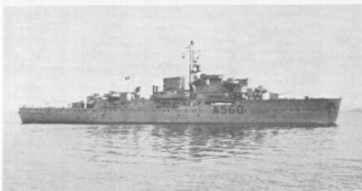
«Egvin». Længde: 90 m. Tonnage: 2.620 t. Fart: 17 knob. Sæsat: 1938. Besætning: 262 ind. Armering: 2 stk. 12,7 cm pk., 6 stk. maskinrøg.
