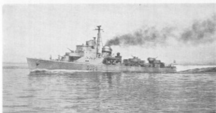
«Halsfjelds». Længde: 86,5 m. Tonnage: 780 t. Fart: 35 knob. Sæsat: 1943. Besætning: 100 ind. Armering: 2 stk. 10,5 cm pk., 9 stk. maskinrøg, 6 stk. 53,3 cm top-, mine- og dybdeborer.
